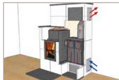
Poêle combiné (en complément du système de chauffage) avec récupérateur de chaleur.
