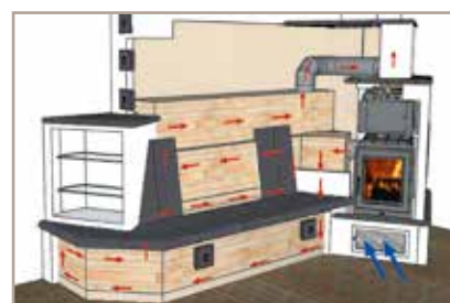
Avec une rehausse hydraulique (pour le branchement à votre système de chauffage centrale) et récupérateur de chaleur maçonné.
